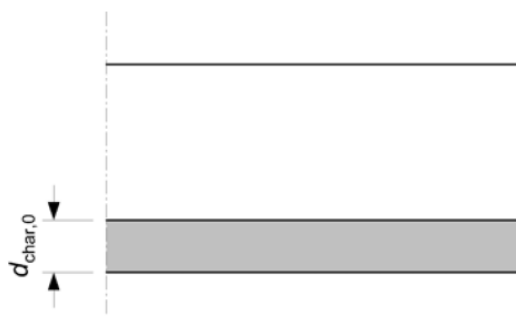
Figura 1: carbonizzazione monodimensionale su pannelli in legno.
