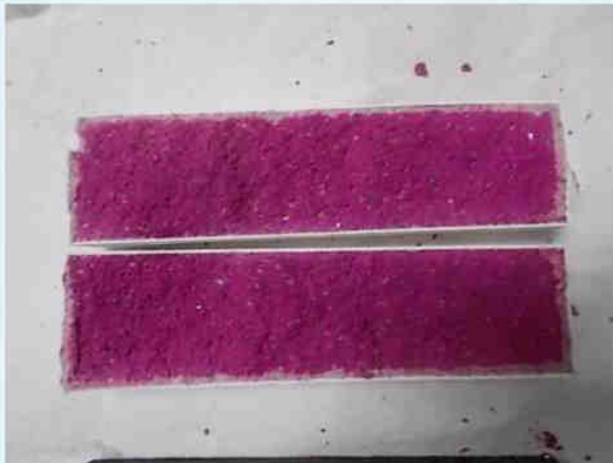
Fotografie dei prismi di calcestruzzo "P1" e "P2" dopo la prova.
